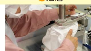
超音波溶着機でパーツを圧着し、マスク
